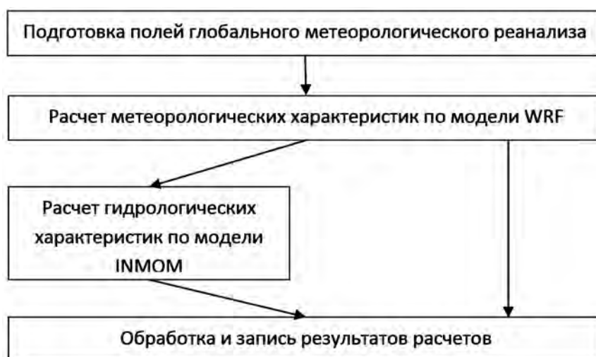
Рисунок 6.27. Блок-схема ретроспективного воспроизведения гидрометеорологических полей
