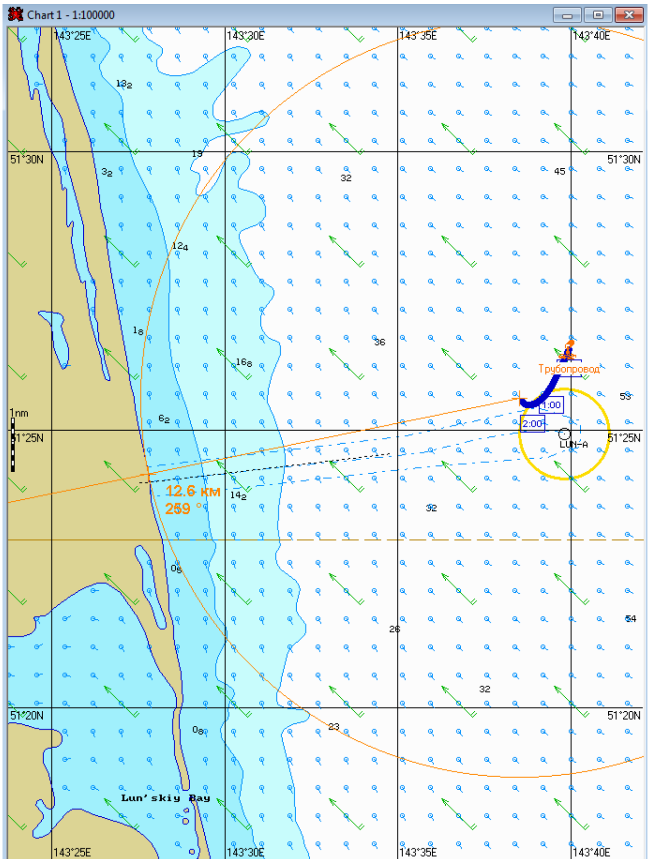
Рис. 2А.3.3. – Карта ЧС(Н) на 2 часа 34 минуты с момента разлива (расстояние от нефтяного пятна до береговой черты) (полное рассеивание)
