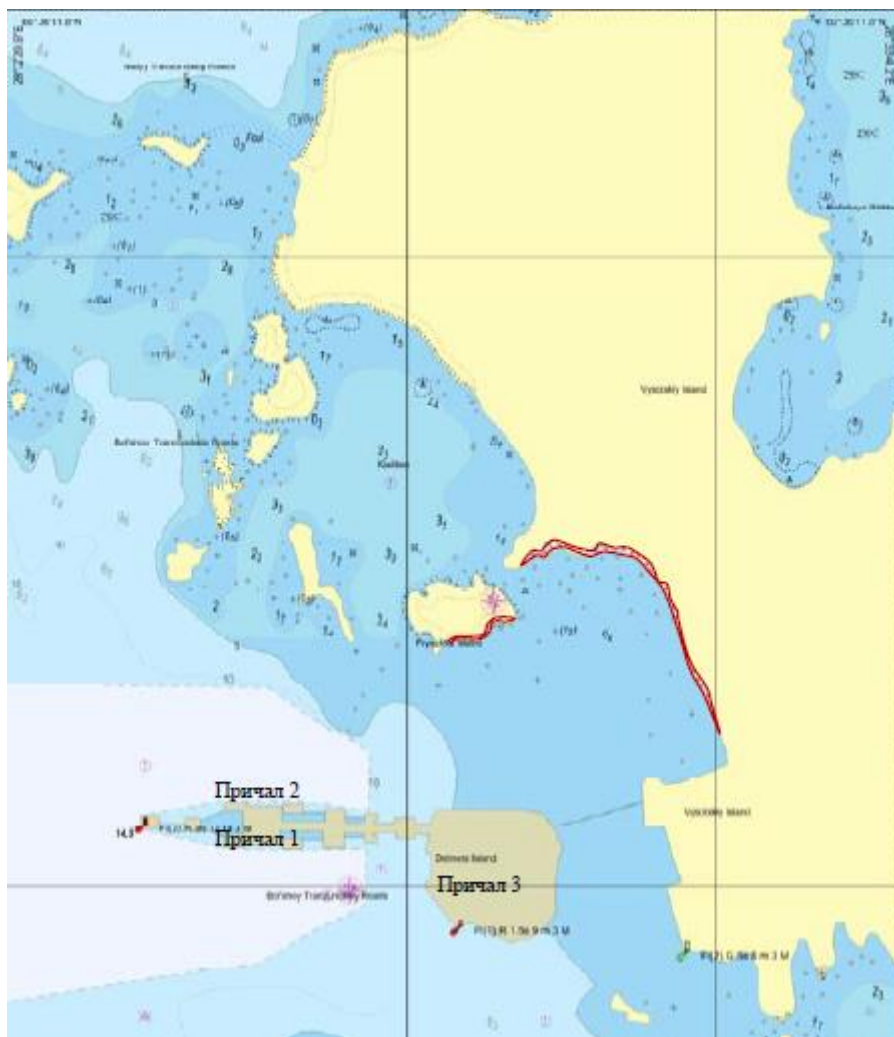
Рисунок 2 - Зона распространения разлитого дизтоплива при юго-западном ветре через 30 мин с момента разлива
