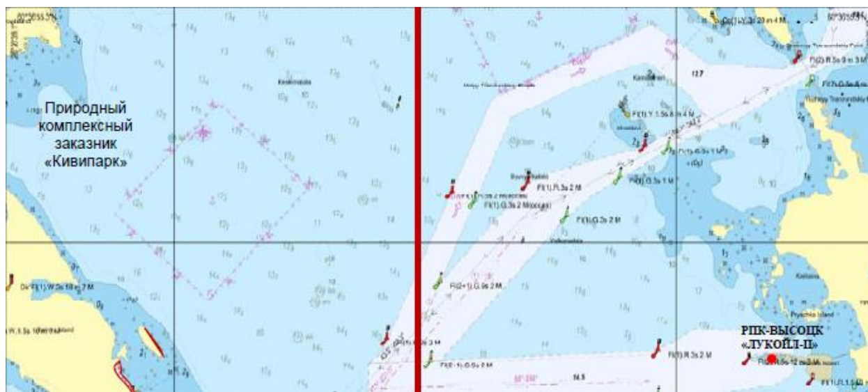
Рисунок 10 - Зона распространения разлитого дизтоплива при восточном ветре через 3 часа с момента разлива
