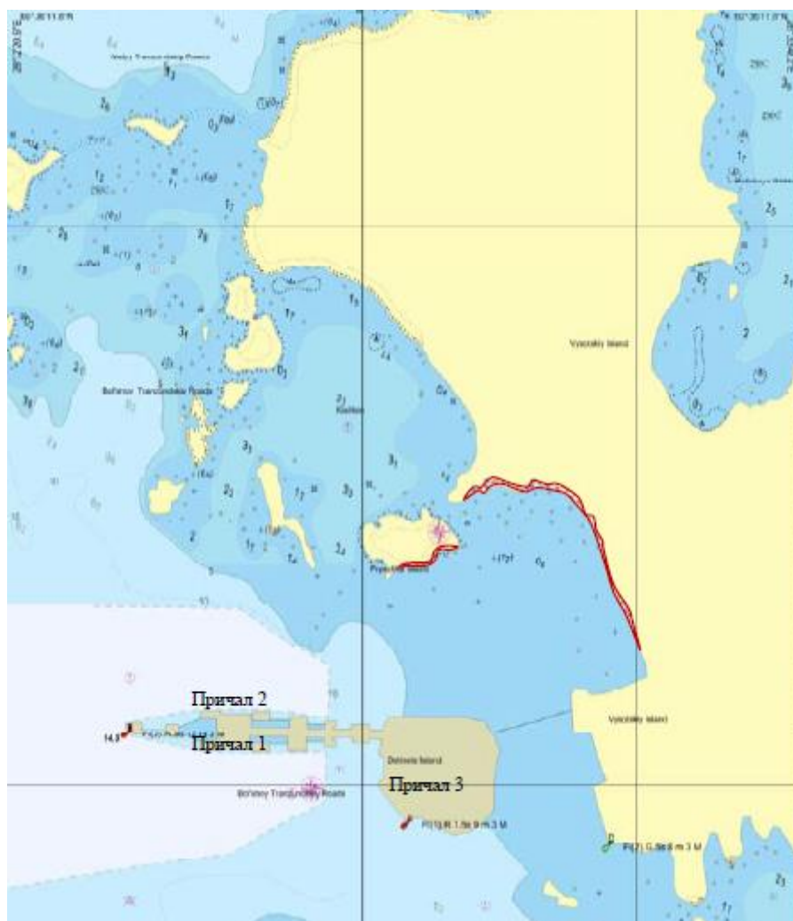
Рисунок 3 - Зона распространения разлитого бензина при юго-западном ветре через 30 мин с момента разлива
