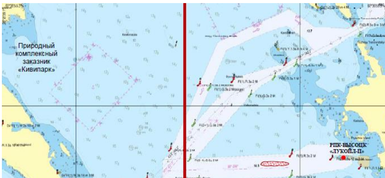
Рисунок 12 - Зона распространения разлитого топлива ТСЭ при восточном ветре через 1 час с момента разлива
