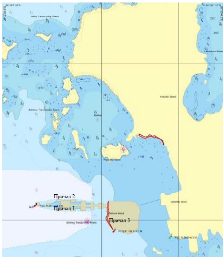
Рисунок 4 - Зона распространения разлитого топлива ТСЭ при юго-западном ветре через 30 мин с момента разлива
