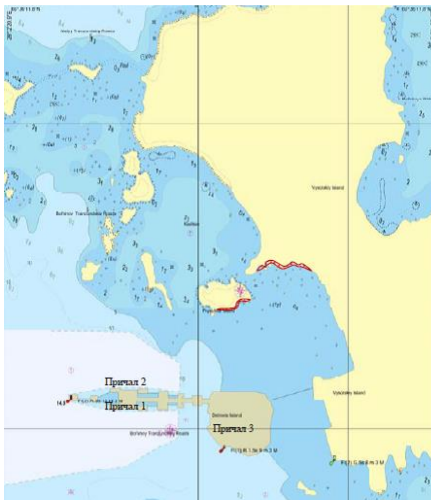
Рисунок 1 - Зона распространения разлитого мазута при юго-западном ветре через 30 мин с момента разлива
