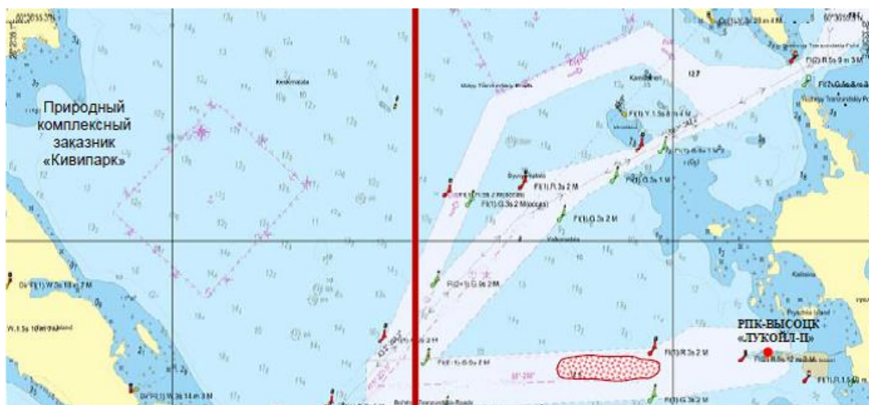
Рисунок 11 - Зона распространения разлитого бензина при восточном ветре через 1 час с момента разлива
