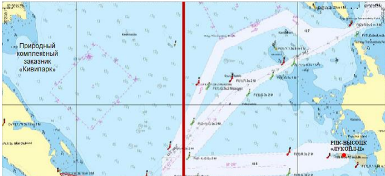
Рисунок 7 - Зона распространения разлитого мазута при восточном ветре через 3 часа с момента разлива
