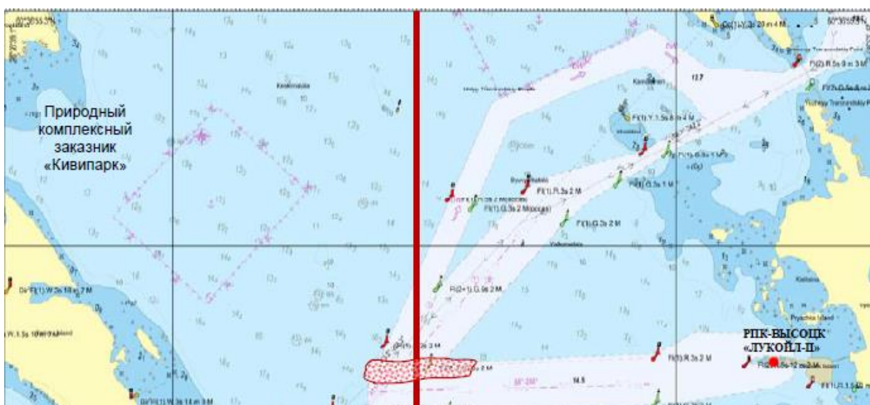
Рисунок 9 - Зона распространения разлитого дизтоплива при восточном ветре через 2 часа с момента разлива
